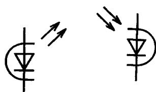
2. Взаимная ориентация обозначений источника и приемника не устанавливается, а определяется удобством вычерчивания схемы, например:
