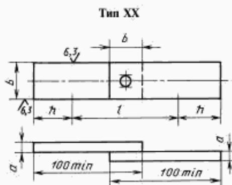
$a$  — толщина основного металла, мм;  $b$  — длина захватной части (выбирают в зависимости от конструкции испытательной машины), мм;  $l$  — длина рабочей части образца, мм
