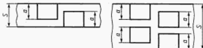
$S$  — толщина сварного соединения;  $a$  — толщина образца
