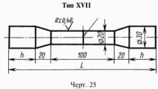
Разрешается применение цилиндрических образцов с другими рабочими диаметрами и другим типом захватной части в соответствии с ГОСТ 1497. Допускается проведение испытаний на образцах типов XII—XVII с более низким классом чистоты обработки при условии соответствия характеристик механических свойств испытуемого металла всем установленным требованиям.
