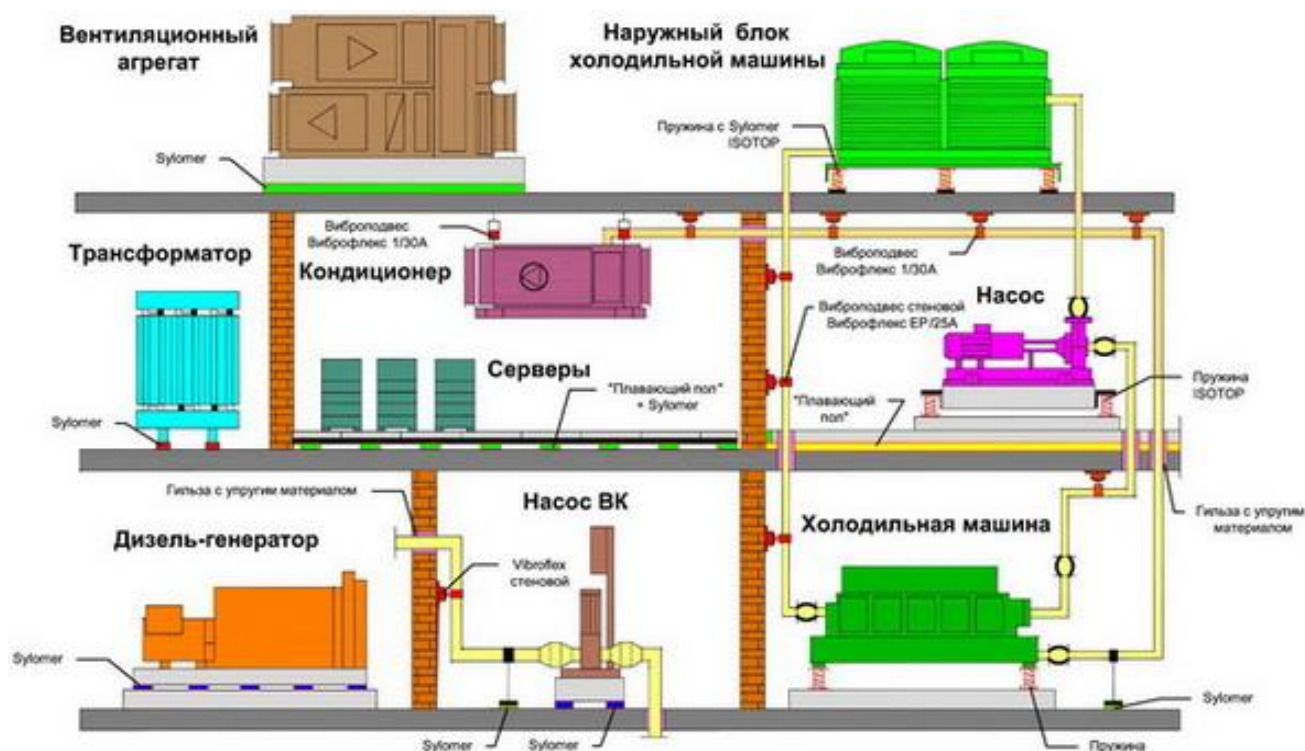
Рисунок 11.14 – Принципы виброизоляции оборудования в здании
