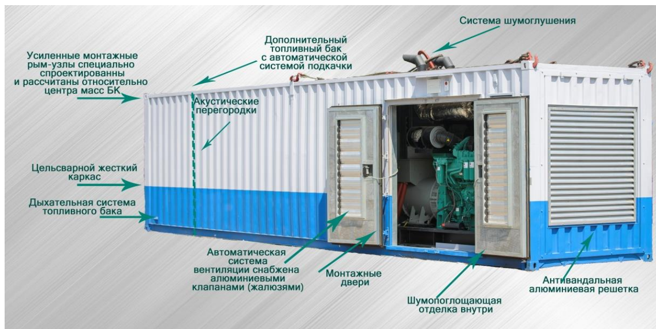
Рисунок 5.2.4 – Блок-контейнер для установки ДГУ / ДЭС
