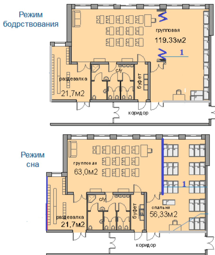
Рисунок 8.2 – Пример использования раздвижной трансформируемой перегородки:
