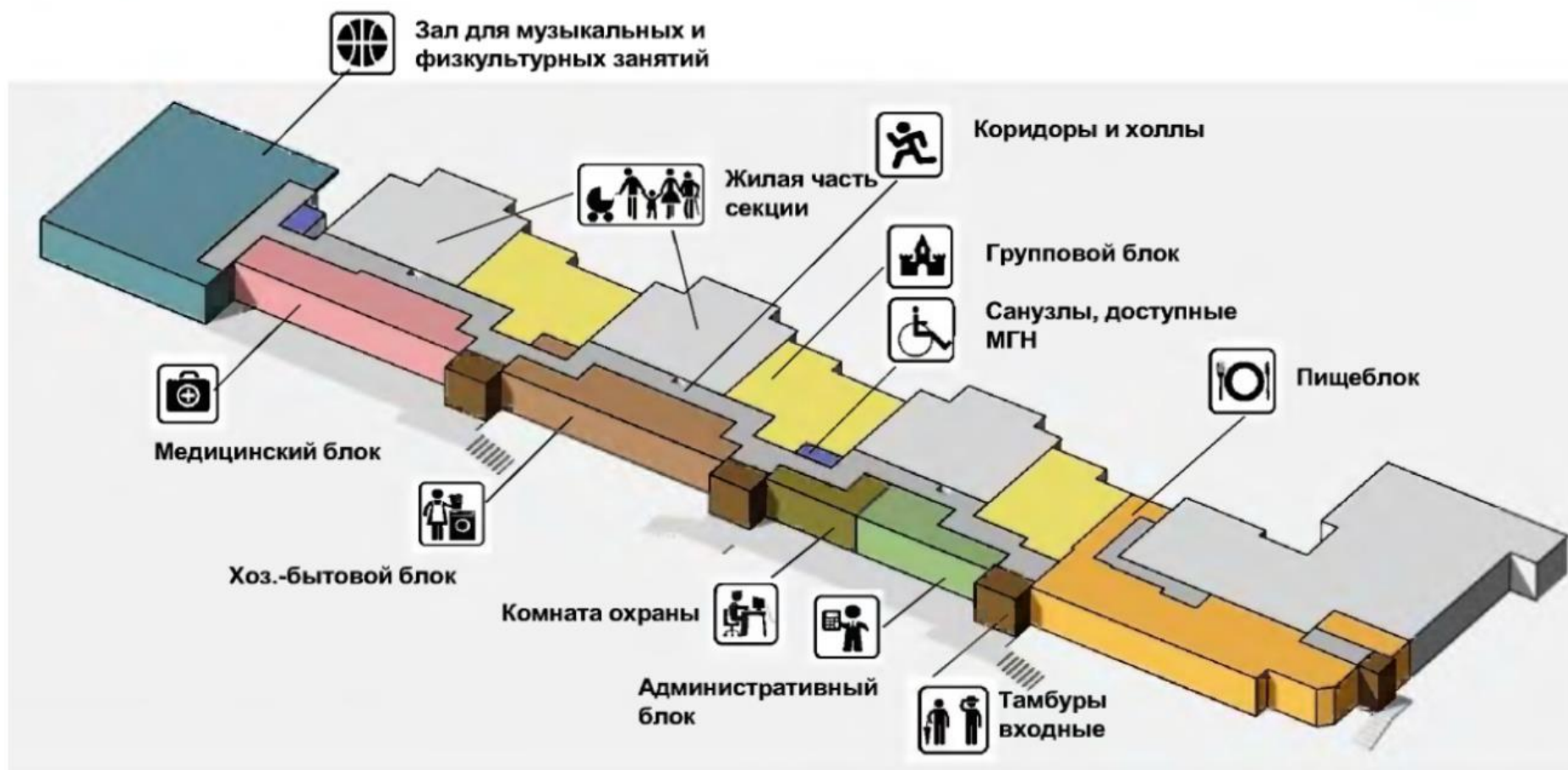
Рисунок Ж1 - Схема функционального зонирования встроенно-пристроенного ДОО
