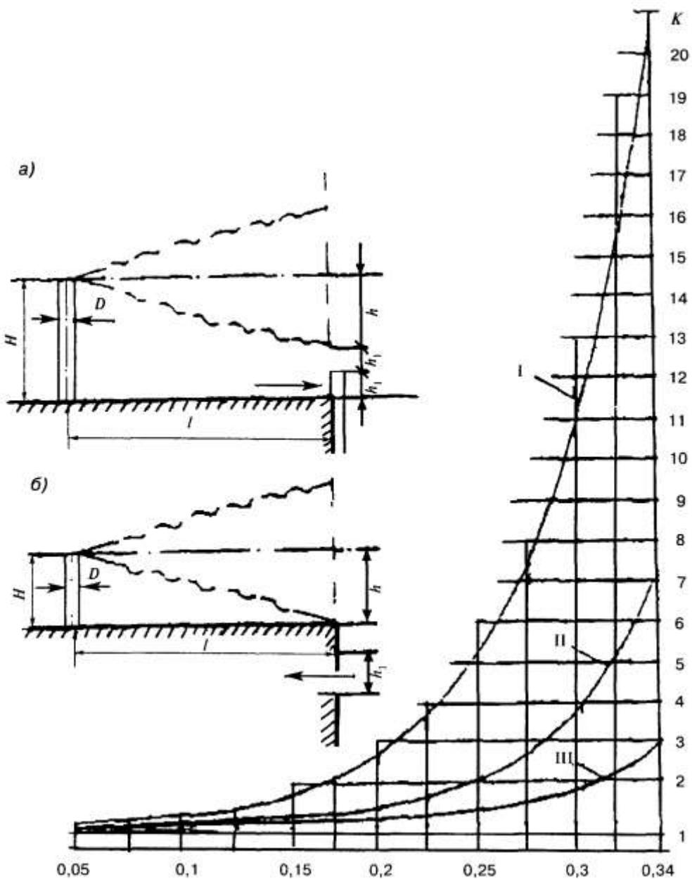
$a$  — расположение источника над зоной всасывания наружного воздуха приемным устройством (высота трубы источника  $H = 2h_1 + h$ );  $b$  — то же, над кровлей здания (высота трубы источника  $H = h$ );
