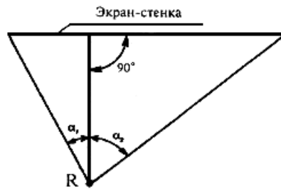
Рисунок 3.15 - Вид сверху экрана конечной длины
