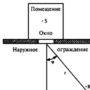
Рисунок 3.1 - Схема для определения угла \varphi между нормалью к наружному ограждению и направлением в расчетную точку
