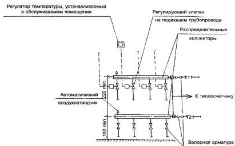
Рисунок 7 - Распределительный коллектор системы отопления
