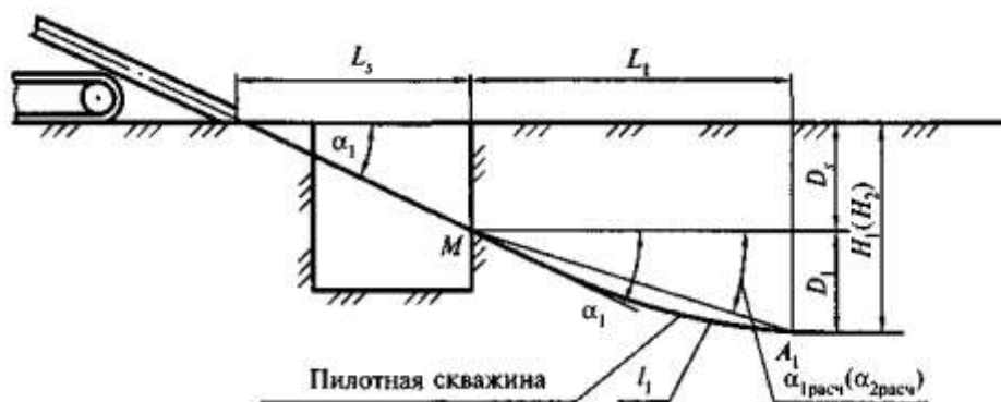
Рисунок Л.2 — Схема забуривания пилотной скважины
