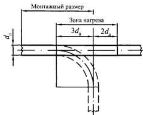
Рисунок 14 — Определение зоны гибки и зоны нагрева перед гибкой для исполнения дуги под углом 90^\circ
