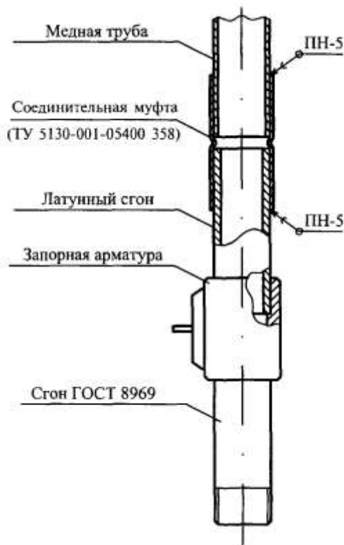
Рисунок 6 — Присоединение запорной арматуры к медному газопроводу
