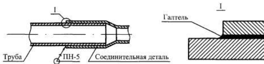
Рисунок 16 — Схема паяного соединения
